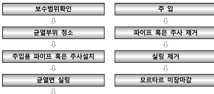
[그림 7.3.3] 주입공법의 시공순서
